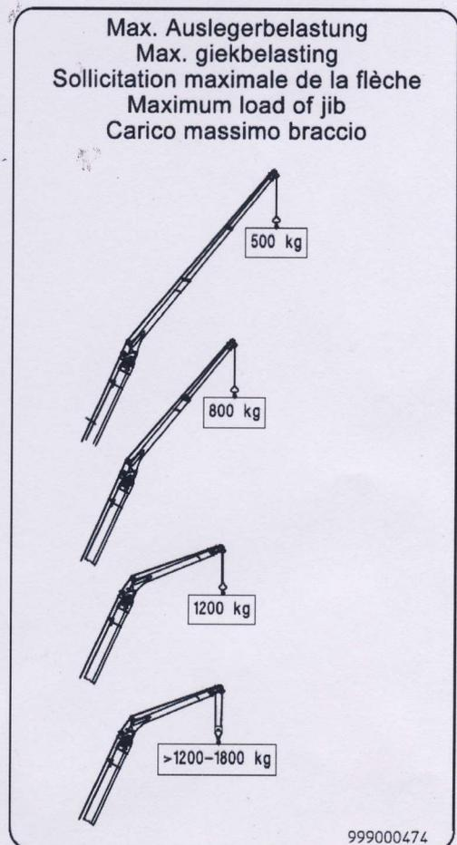
Durch ändern der Systemparameter Index 1 auf 500 und Index 2 auf 800 in der Steuerung wird die Erhöhung zugelassen.
