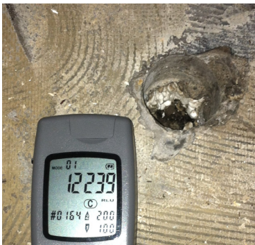
Abbildungen: Links Teströhrchen, oben Extremwert an einer Förderanlage für Lebensmittel, unten Test an einer Kernbohrung zur Dämmschicht im Bodenaufbau
